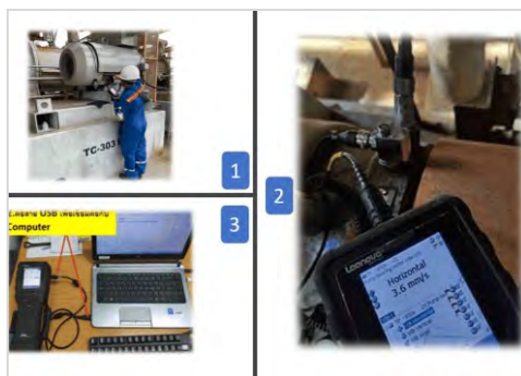
ภาพที่ 2.2-55x ระบบ Vibration Monitoring
